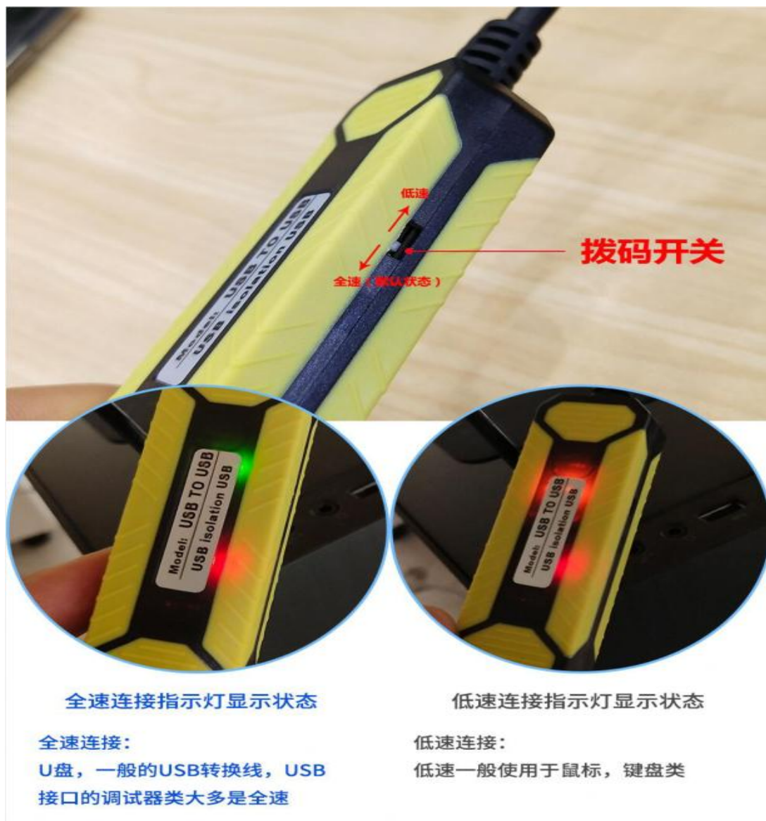
图 1 USB TO USB 低速/全速切换示意图
