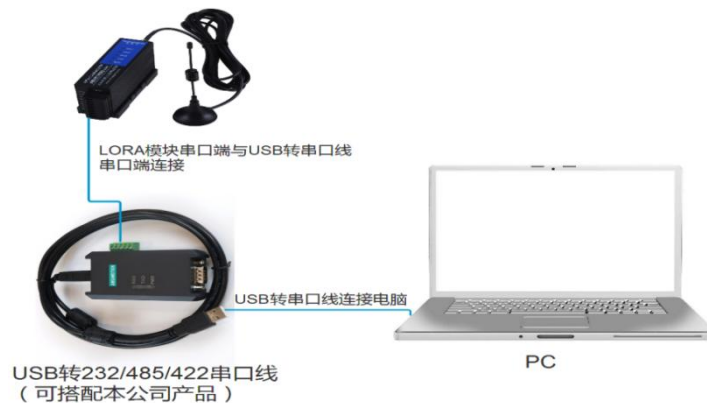
图 5.2 LORA 模块参数设置接线示意图
