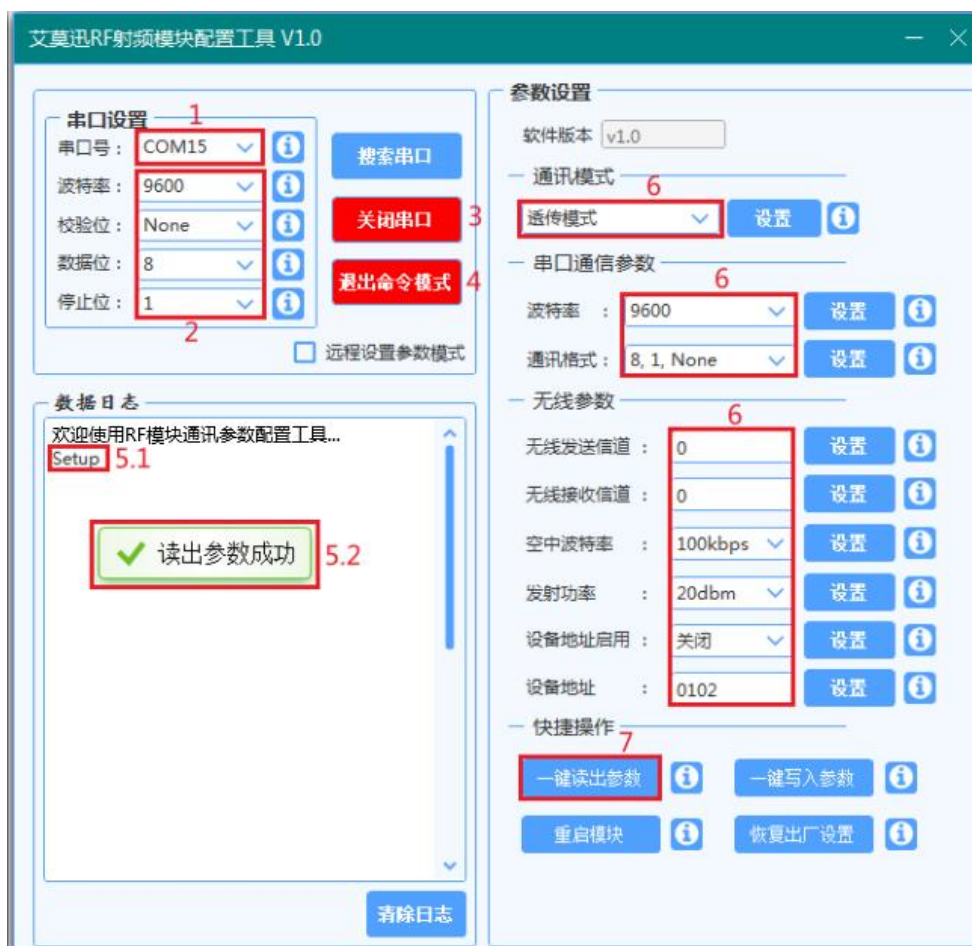
图 7.2.1 配置工具的连接与模块参数读取
