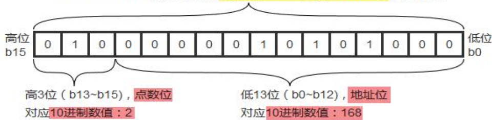
MODBUS TCP 服务器分配寄存器D8477值为H40A8时的位状态
