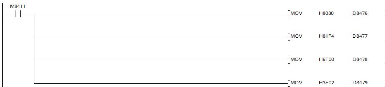
上图 MODBUS TCP 服务器设定程序例程中软元件的说明如下:
