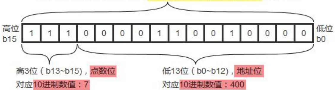
MODBUS TCP 服务器分配寄存器D8479值为HE190时的位状态
