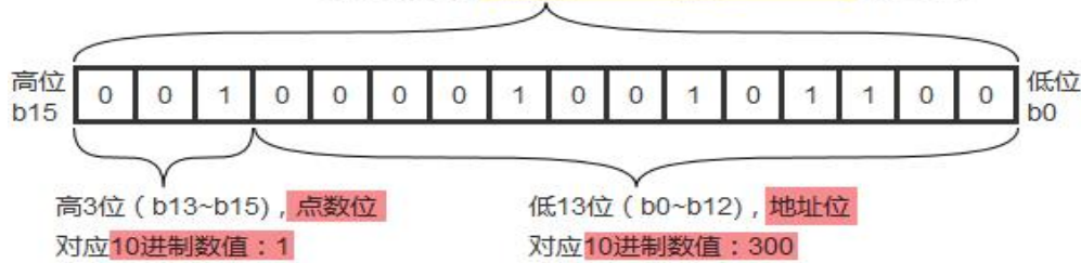
MODBUS TCP 服务器分配寄存器D8477值为H212C时的位状态
