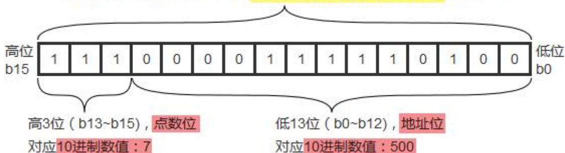
MODBUS TCP 服务器分配寄存器D8477值为HE1F4时的位状态
