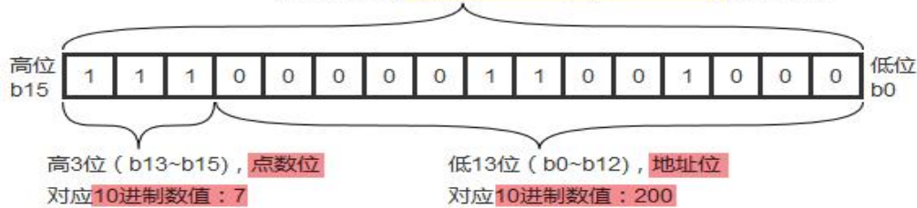
MODBUS TCP 服务器分配寄存器D8478值为HE0C8时的位状态
