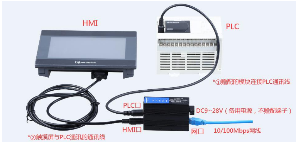
图 4.1 ETH-FX-2P 接线参考
